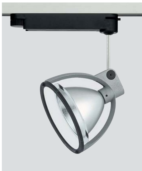
0010764 mit 3-Phasen Stromschienen- adapter mit integriertem Transformator 240/12V 105VA Fassung GY6,35 für Lampen QT12 50-90W 12V 3-phase track adapter, integrated Transformer 240/12V 105VA socket GY6,35 for lamps QT12 50-90W 12V
